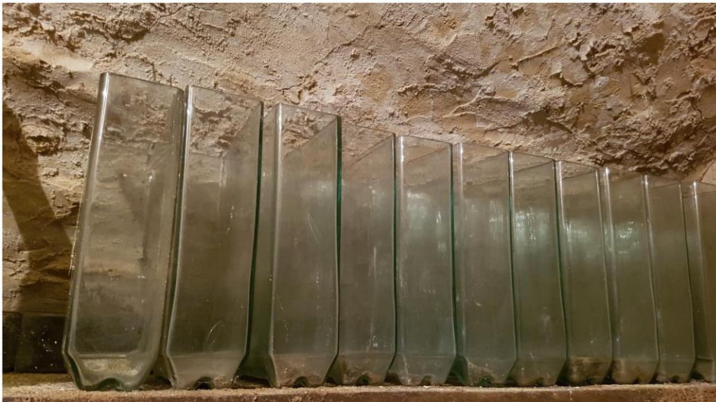
Série d'anciennes cuves en verre pour piles, il manque les électrodes
